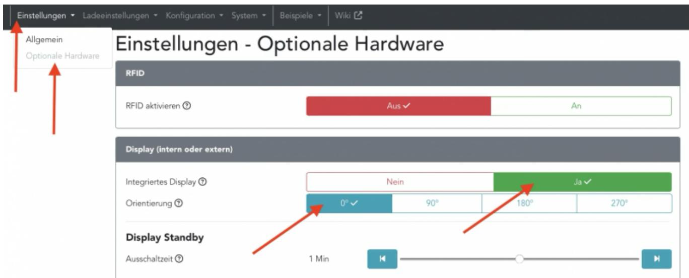
Ferner gibt es dort eine Option, den **Bildschirm zu drehen**. Die Ausrichtung **0 Grad** ist für Displays in der openWB **custom, standard+, Pro+** korrekt, 180 Grad ist für Displays der **openWB Standalone** (reiner Steuercontroller ohne Ladehardware). Nach dem Umstellen bitte nicht vergessen, am Ende der Konfigurationsseite auf **[Speichern]** zu klicken.
