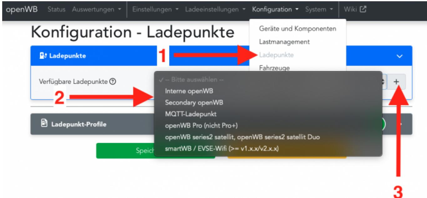
Nachfolgend ist die beispielhafte Konfiguration einer internen openWB mit Phasenumschaltung beschrieben.
