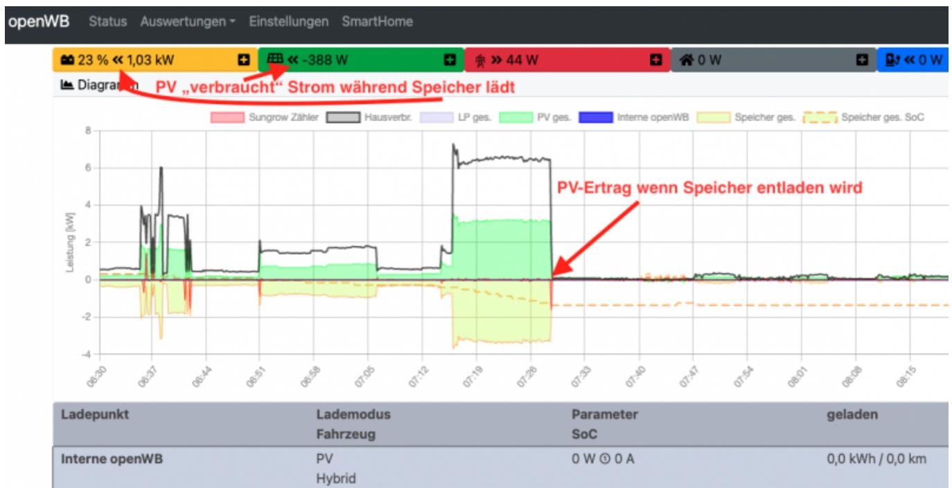
Bei einem Hybrid-System mit DC-Anbindung muss zwingend auch immer die Leistung des Wechselrichters im Lastmanagement angegeben werden. Hintergrund ist, das PV-Ertrag **und** Speicherentladung bei so einem System über einen Wechselrichter laufen und darum **zusammen** durch dessen maximale Leistung begrenzt sind. Beispiel: Die PV-Module können maximal 8kW produzieren, der Speicher kann mit maximal 8kW entladen werden, die Leistung des Wechselrichters
