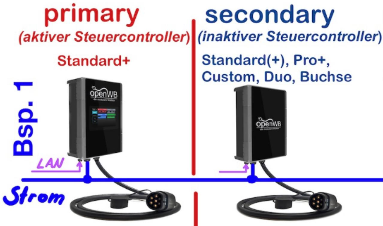
**Beispiel 2:** Es gibt an einem Standort einen externen Steuercomputer **openWB Standalone** und eine openWB standard+. Der externe Steuercomputer ist hier die sogenannte **Primary**, also die steuernde Instanz, ohne einen internen Ladepunkt (ohne eigene Ladehardware).
