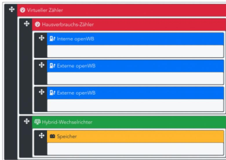
Ist der Zähler wie üblich am EVU-Punkt installiert und misst den gesamten Verbrauch/Einspeisung, muss die Struktur wie folgt aussehen:
