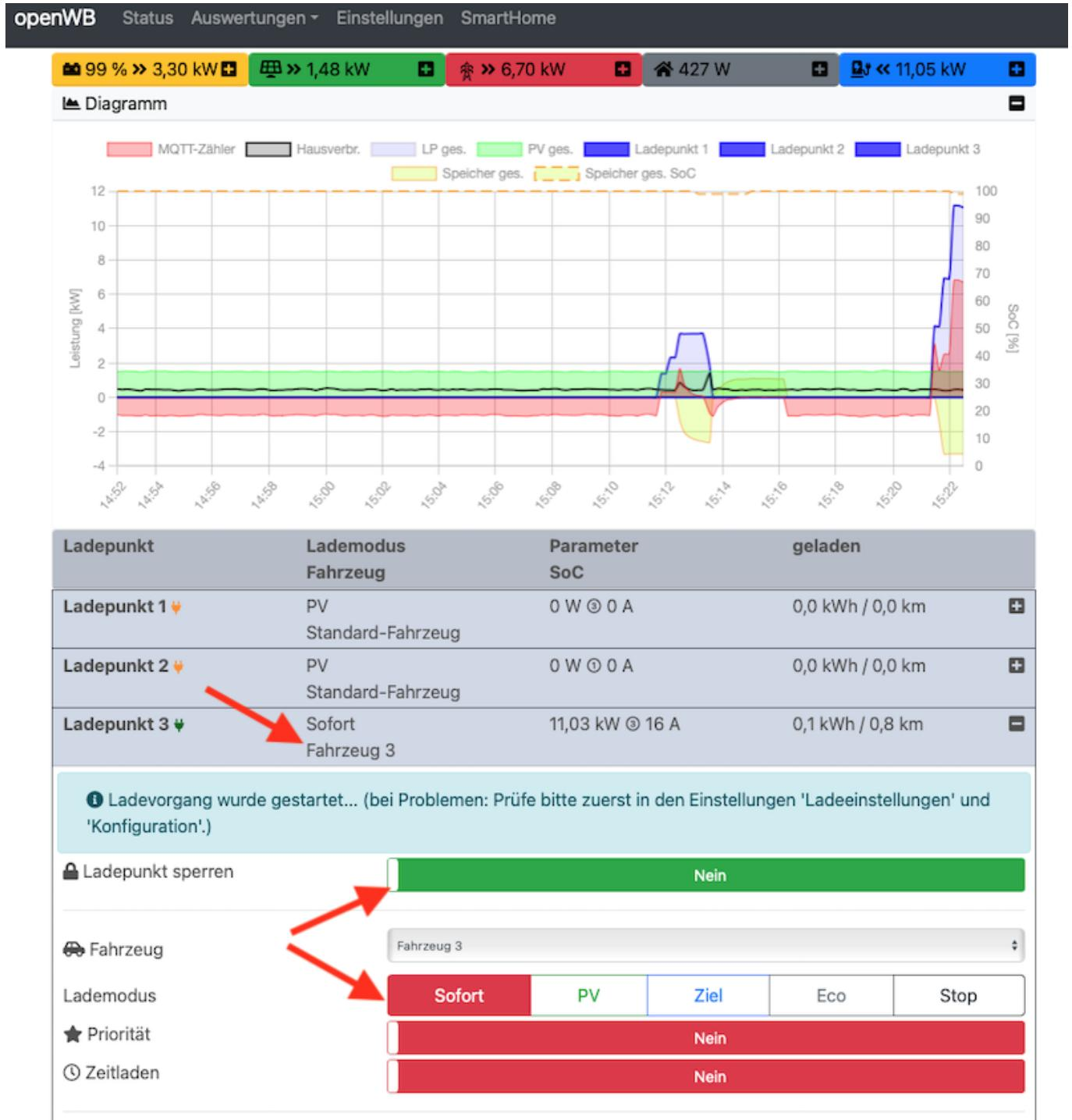
Wie man im Bild oben sieht, ist an Ladepunkt 3 das automatisch per ID-TAG/Nummer gescannte/eingegebene Fahrzeug 3 **eingebucht**. Hiermit wird der Ladepunkt auch auf den voreingestellten **Lademodus** des Fahrzeugs 3 (hier **Sofort**) umgestellt.
