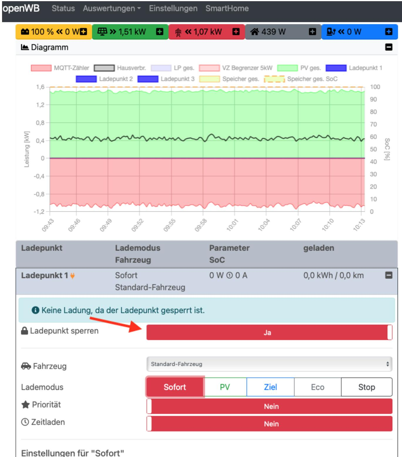
Ist der Ladepunkt auf diese Weise gesperrt und es wird nun einer der hinterlegten TAGs/Nummern gescannt/eingegeben, wird der Ladepunkt **entsperrt**.
