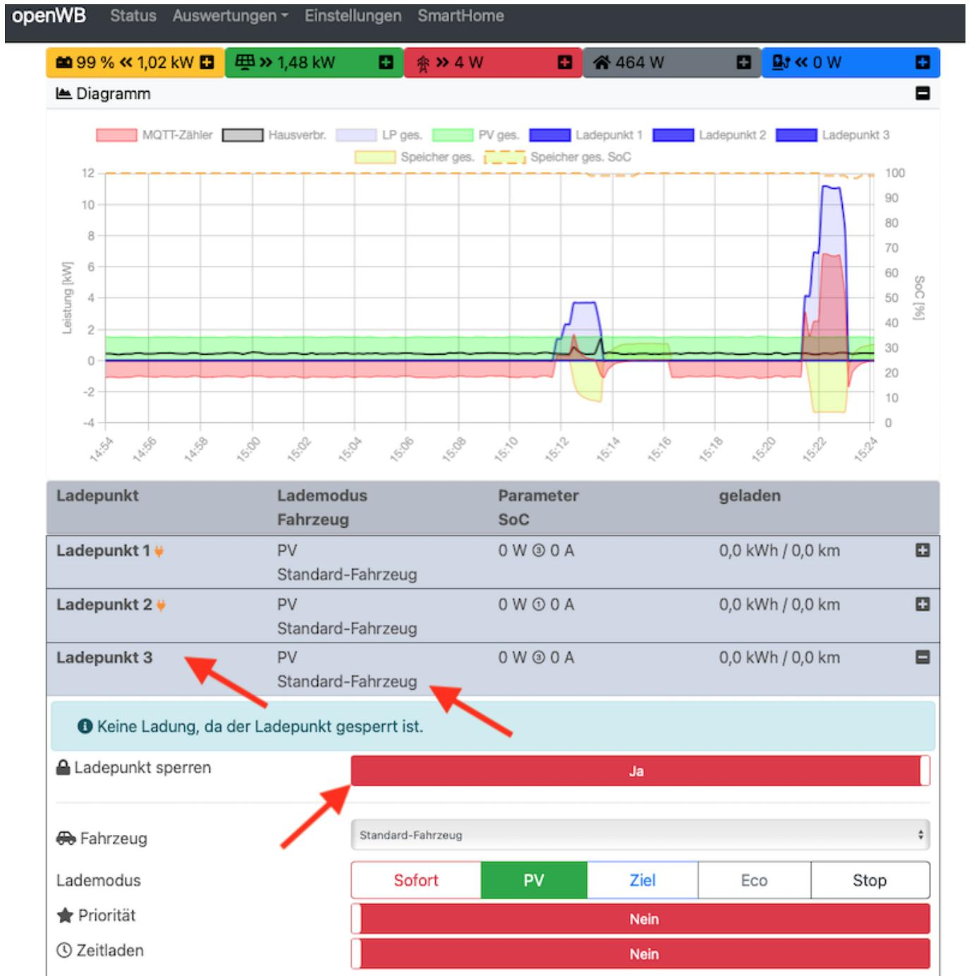
Im Bild ist zu sehen, dass nach dem Abstecken von Fahrzeug 3 (das Stecker-Symbol am Ladepunkt ist verschwunden) wieder das Standard-Fahrzeug und dessen Lade-Profil (hier PV-Laden) dem Ladepunkt zugeordnet wurde.
