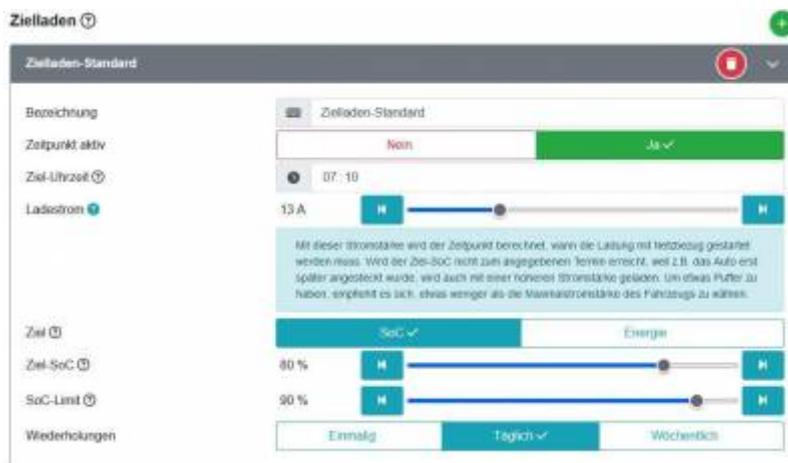
Einstellbar ist der Ziel SoC, der in vielen Fällen auf 80% eingestellt wird, da eine höhere Ladung den Akku des EV überproportional belastet. Dennoch sollte ab und zu der Akku auf 100% geladen und dort über kurze Zeit gehalten werden, damit die Zellen sich wieder balancieren können. In dem oben gezeigten Beispiel ist der Ladestrom mit 13A eingestellt. Somit bleibt bei einem 3-phäischen 11kW-Lader noch Reserve, um die Stromstärke kurz vor Ende ggf. noch zu erhöhen.
