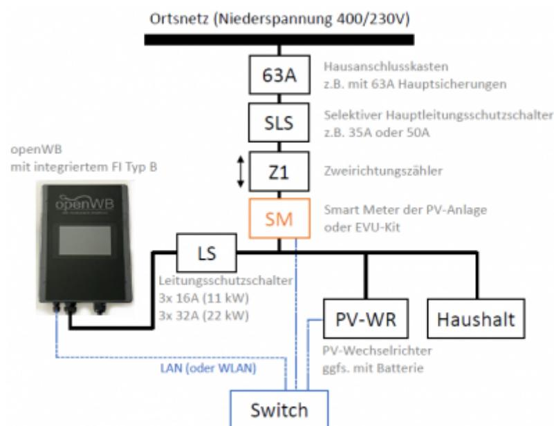
Ausgehend vom Ortsnetz findet sich im Haus zuerst der Hausanschlusskasten mit den Hauptsicherungen.
