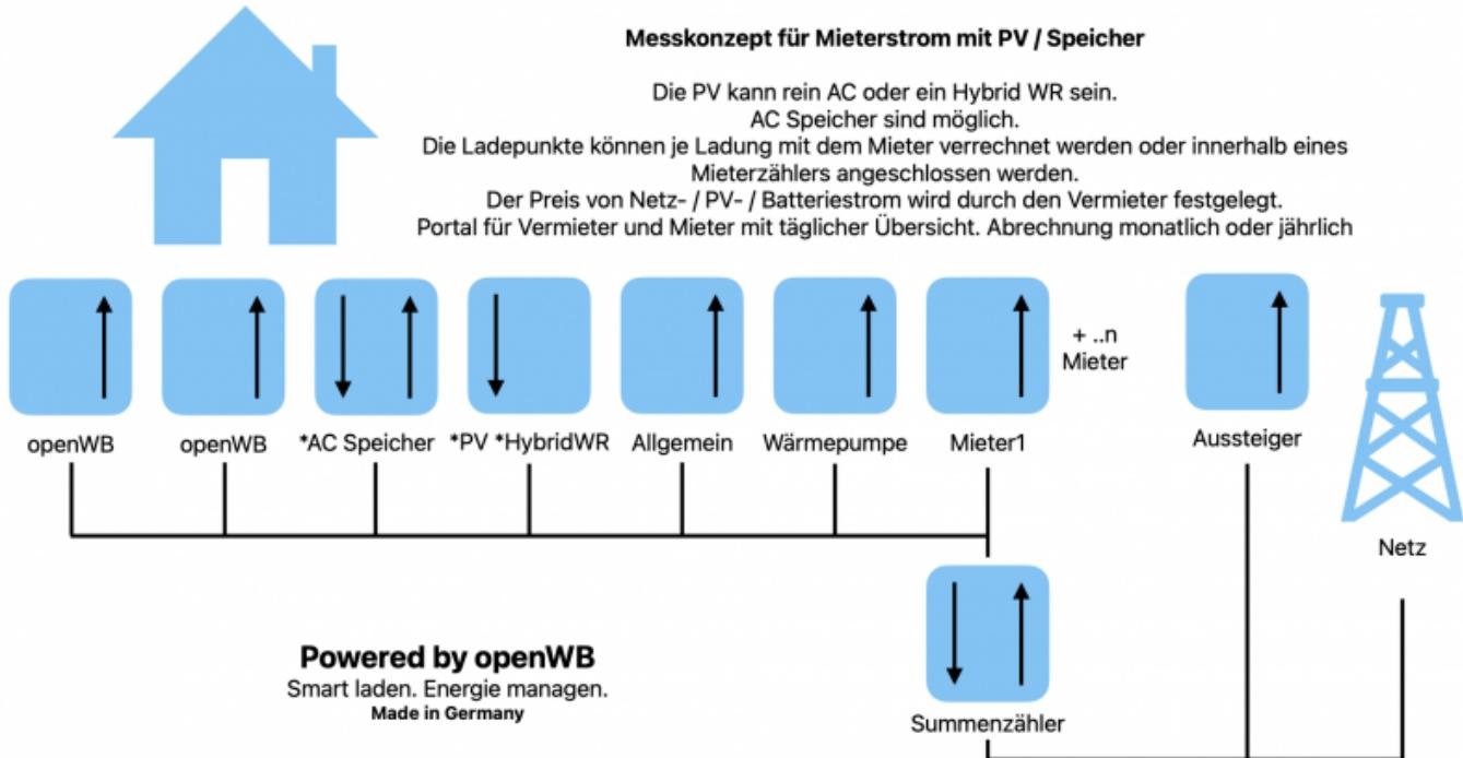
Die openWB Cloud muss aktiv und funktional sein, heißt, die openWB benötigt eine Internetverbindung für die Übermittlung der abrechnungsrelevanten Daten.
